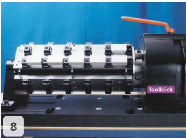
7 72 Teile sind hochgenau gespannt unter 10 my. Die Vorrichtungen sind auf einem EROWA ITS O-Punkt Spannsystem aufgebaut 72 parts are clamped within 10 microns the clamp fixtures are set up on a EROWA ITS palleting system
