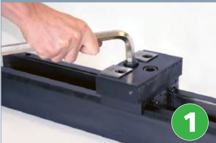
Zwei Schraube lösen Loosen two screws
