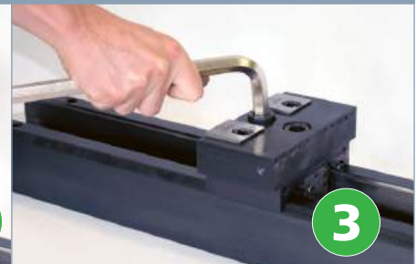
Zwei Schrauben anziehen Fasten two screws
